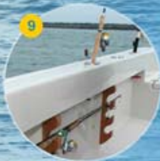
Largeur franc-bord de 18cm avec 3 porte-cannes encastrés de chaque côté et hauteur de franc-bord
