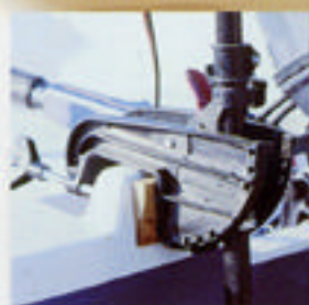
Support moteur électrique
